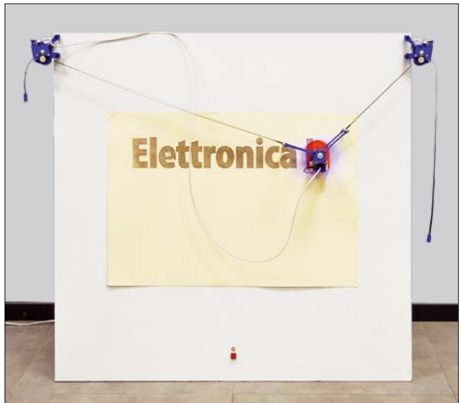
Complesso del Vertical Laser Engraver visto dal davanti, montato e operativo su un foglio di cartoncino.
